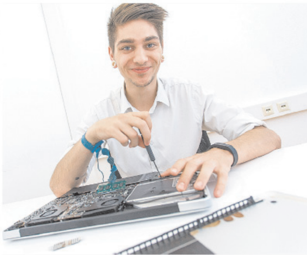
Philippe Verant schützt sich und die sensiblen elektronischen Teile mit einem antistatischen Band, bevor er den Laptop mit „Kaffeeflecken“ zerlegt und schaut, was noch zu retten ist.
